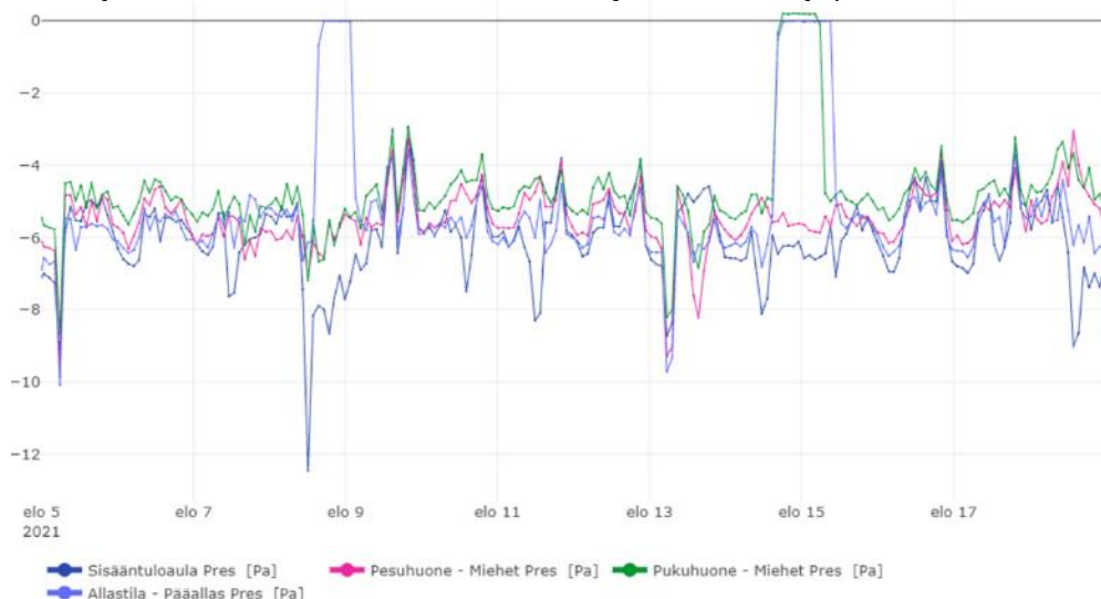
Kuva 107. Suoritetujen paine-eromittausten paine-erokuvaajat. Kuvaajat on piirretty 100 min liukuvan keskiarvon mukaan.
