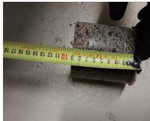
Kuva 5. Alapohjalaatta on noin 90 mm vahvuisen
